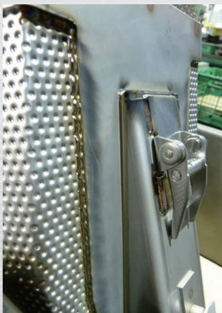
ファイバーレーザー溶接で接合された計量器ユニット
