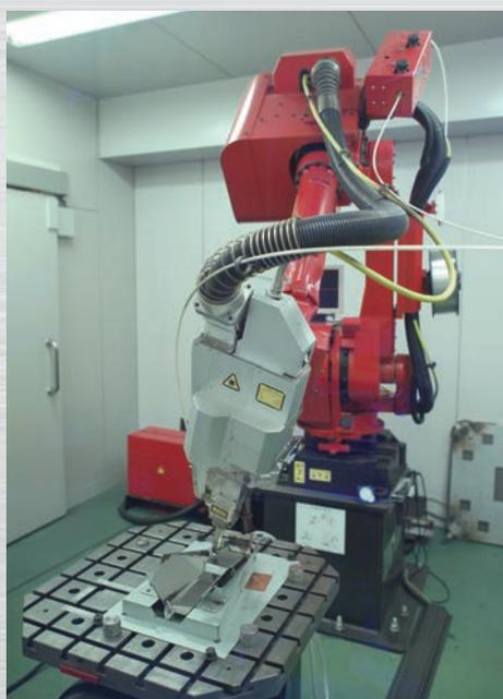
ファイバーレーザー溶接ロボットFLW-4000による溶接
